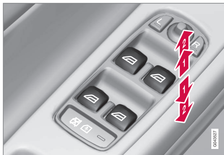
Fonctionnement des vitres électriques
