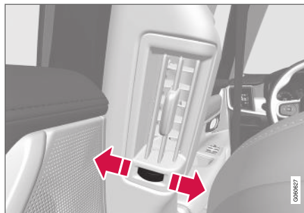
Rotella della bocchetta di ventilazione 2 .
