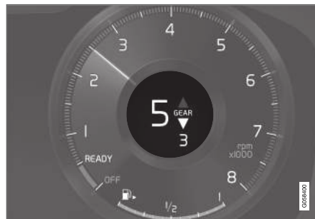
Indicatore cambio di marcia sul display del conducente da 12".
