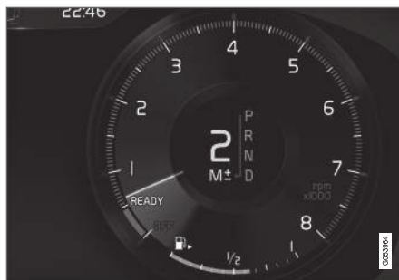
Modalità di cambio marce manuale nel display del conducente 3 .
