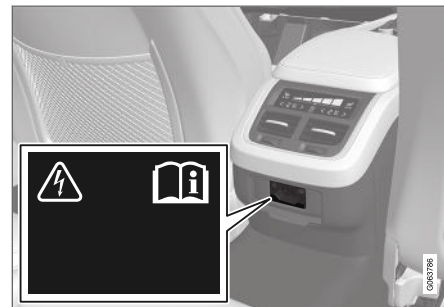
Presa elettrica nel tunnel, sedile posteriore.
