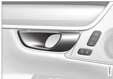
Maniglia per lo sbloccaggio alternativo nella portiera.
