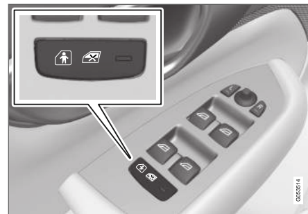
Pulsante di attivazione e disattivazione elettrica.
