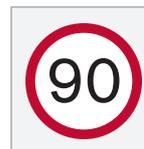
O Aviso de velocidade é efectuado através de um símbolo do mostrador do condutor a piscar com a velocidade máxima permitida aplicável enquanto a mesma é ultrapassada.
