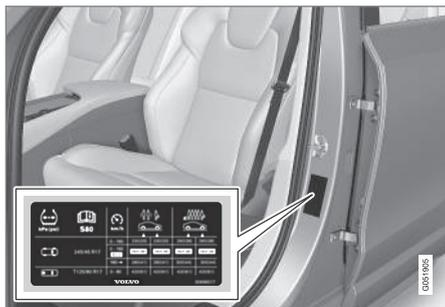
O autocolante da pressão dos pneus no pilar da porta do lado do condutor (entre a porta dianteira e traseira) indica as pressões correctas dos pneus para diferentes condições de carga e velocidades.
