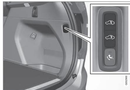
Utilize os botões no compartimento da carga para regular a altura da secção traseira e facilitar a carga/descarga ou conexão/desconexão de um atrelado. Ver capítulo "Carga".
