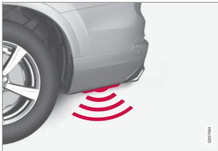
Se o automóvel estiver equipado com o acessório Chapa de Protecção/Difusor\*, o sensor encontra-se junto ao canto esquerdo do pára-choques.
