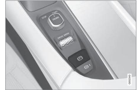
O comando do travão de estacionamento encontra-se na consola de túnel entre os bancos.
