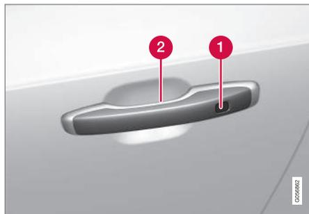
Reentrância no lado exterior do puxador da porta para trancagem. Superfície sensível ao toque no lado interior para destrancagem.
