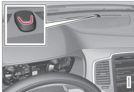
O indicador de trancagem e de alarme no tablier apresentam o estado do sistema de alarme.
