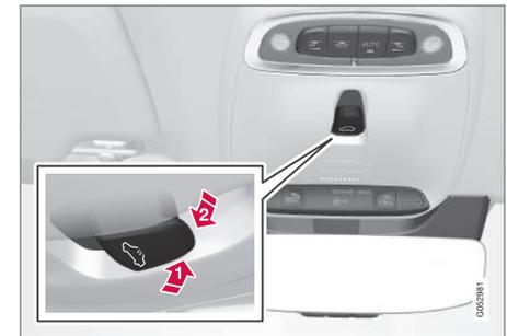
Posição de ventilação, vertical na margem traseira.
