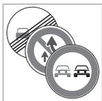
Juntamente com o símbolo da limitação de velocidade aplicável pode ser exibida uma placa complementar, por ex.: proibição de ultrapassagem ou proibição de mudança de faixa.
