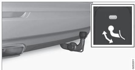
3. Desloque o engate de reboque para a sua posição final onde este fixa e bloqueia - a luz indicadora assume luz fixa cor-de-laranja.
