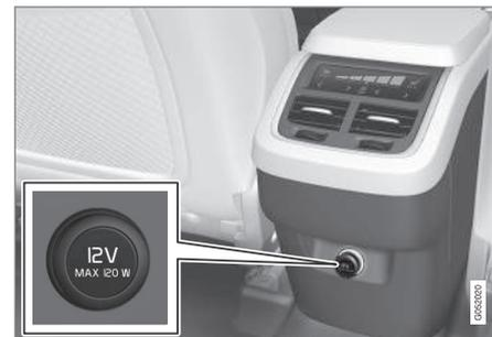
Tomada eléctrica 12 V na consola de túnel, segunda fila de bancos.
