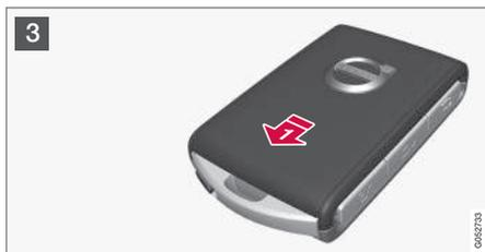
3 **1**▶ Após a utilização, recoloca a parte da chave no seu lugar no comando à distância. Volte a colocar a tampa e desloque-a para a sua posição.
