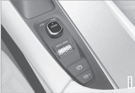
Disco de arranque na consola de túnel.
