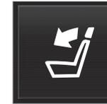
Pressione o botão **Rebat apoio cabeça** para activar/desactivar o rebatimento.
