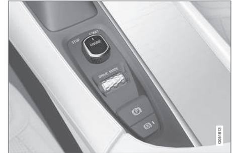
Disco de arranque na consola de túnel.
