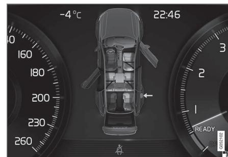
Gráfico no mostrador do condutor com diferentes tipos de avisos. A cor de aviso das portas e da tampa do porta-bagagens depende da velocidade do automóvel.
