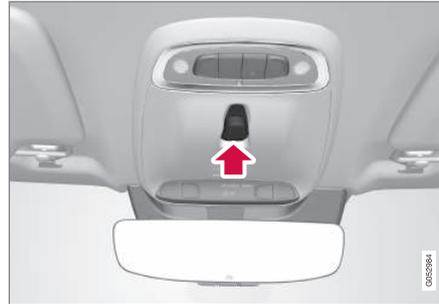
O teto panorâmico e a cortina são acionados com um comando que se encontra no teto. O comando é ativado quando o sistema elétrico do automóvel está na posição de ignição **I** ou **II**.
