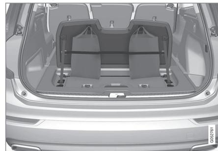
Existem dois sacos para compras e uma cinta elástica<sup>2</sup> na tampa, que faz parte do alçapão, no compartimento de carga. A cinta pode ser montada de quatro formas diferentes.
