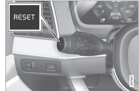
Reinicie o totalizador parcial TM com uma longa pressão no botão **RESET** na alavanca do volante do lado esquerdo.
