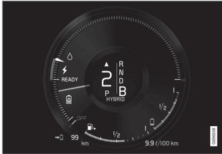
O automóvel gera corrente para a bateria e a bateria é carregada, por ex.: com ligeiras pressões no pedal do travão ou com travagem com o motor em descidas.
