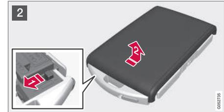
**2** **1** Desloque o botão para o lado e desloque a parte de trás da tampa alguns milímetros para cima.
