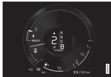
O mostrador do condutor indica carregamento na travagem com o motor.
