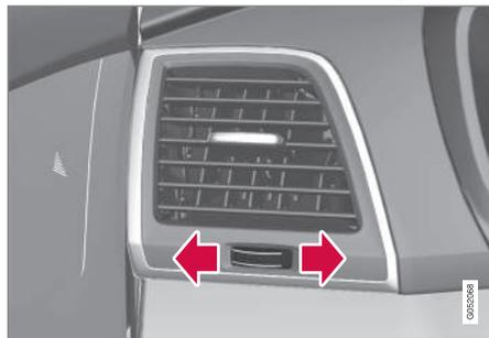
Selector rotativo da boca de ventilação<sup>1</sup>.
