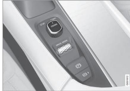
Disco de arranque na consola de túnel.
