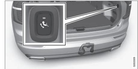
1. Abra a tampa do porta-bagagens. Na parte de trás do painel lateral direito do compartimento da carga existe um botão para retração e rebatimento do engate de reboque - para que a função de rebatimento esteja activa é necessário que esteja acesa uma luz indicadora cor-de-laranja no botão.
