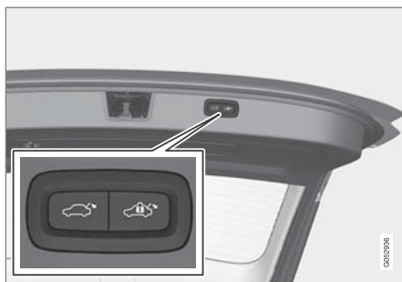
テールゲートの下側にある閉操作およびロック用ボタン
