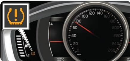
Kalibrering er alltid nødvendig etter dekkskift eller endret dekktrykk. Når lyset tennes, (⚠) må systemet kalibreres. Gjør slik:
