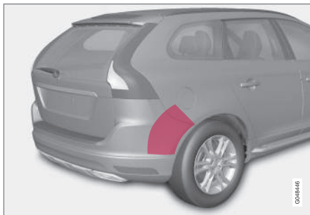
Emplacement des capteurs BLIS/CTA 13
