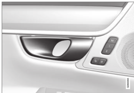
Klamka do alternatywnego odblokowania w drzwiach bocznych 12 .
