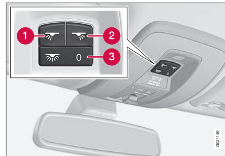
Comando na consola do tecto para as lâmpadas de leitura dianteiras e a iluminação do habitáculo.
