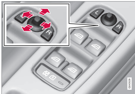
Comando dos retrovisores exteriores.
