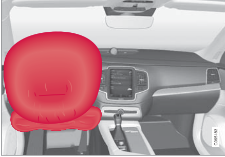
الوسادة الهوائية في عجلة القيادة والوسادة الهوائية عند الركبة في جانب السائق في المقعد الأمامي.
