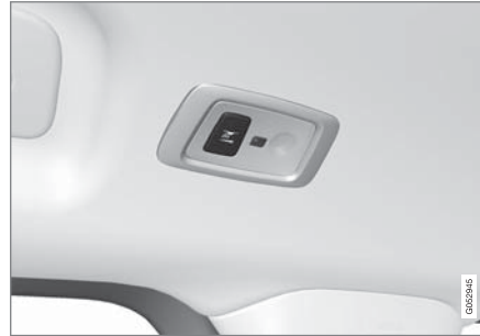
في السيارات المزودة بسقف بانوراما* توجد وحدات مصابيح واحدة في كل جهة من جهتي السقف ١ .
