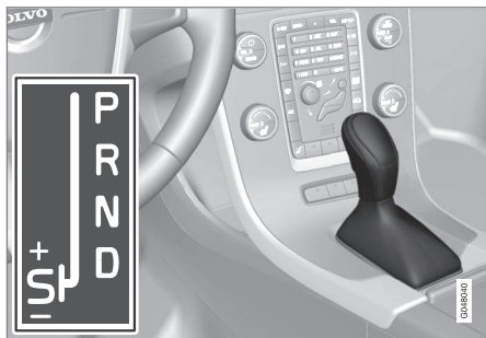
D: Automaattiset vaihdeasennot. +/-: Manuaaliset vaihdeasennot. S: Sport-tila*.
