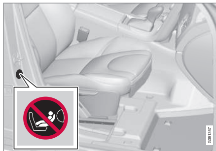
Vaihtoehto 2: Turvatyynyn tarran sijainti matkustajanpuoleisessa ovipilarissa. Tarra tulee näkyviin, kun matkustajan ovi avataan.
