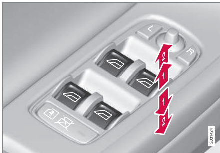
Regulering av vindusheiser.
