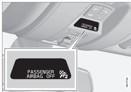
Kontrolllampe som viser at kollisjonsputen på passasjerplassen er deaktivert.
