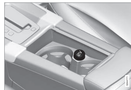
12 V-uttak i tunnelkonsoll, forsete.
