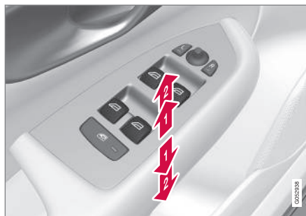
Fonctionnement des vitres électriques.
