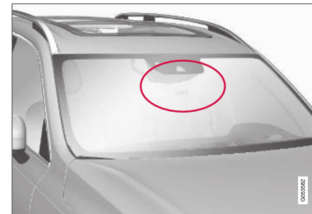
Ubicación de la unidad de radar.
