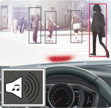
本車配備了具自動煞車功能的撞擊警示系統及自行車騎士與行人偵測系統，可為汽車、自行車騎士及行人煞車及/或停車。
