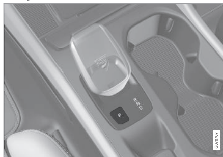
Visão geral da alavanca de marchas e da posição P.
