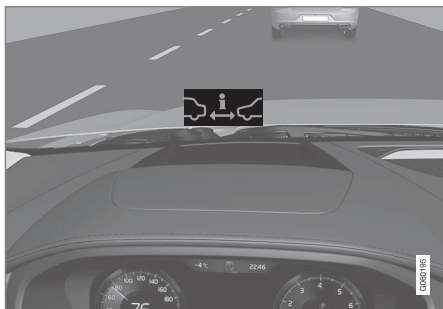
Símbolo do Alerta de distância no para-brisa com visor head-up.
