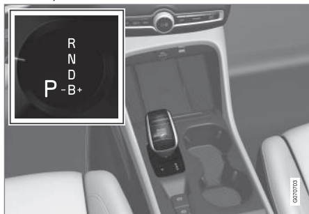
Visão geral da alavanca de marchas e do padrão de mudança de marcha no visor do motorista.
