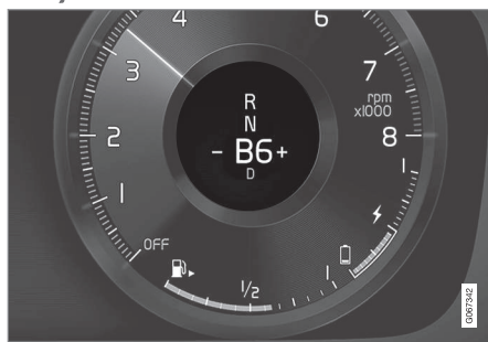
Visão geral das posições de freio e do visor do motorista.
