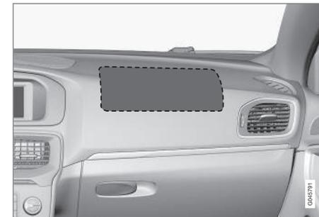
Localização do airbag do lado do passageiro da frente em modelos com volante à esquerda.
