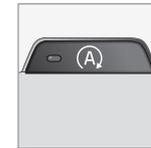
A função Start/Stop activa-se automaticamente quando o motor é arrancado com a chave. O condutor é alertado para a função através do símbolo aceso do botão Ligar/Desligar no instrumento combinado e da luz acesa do botão Ligar/Desligar.
