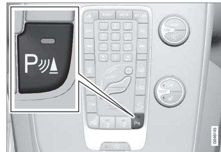
Lig/Desl dos sensores da Assistência ao estacionamento e do CTA<sup>30</sup>.
