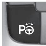
1. Active o PAP pressionando este botão e conduza a uma velocidade inferior a 30 km/h.
