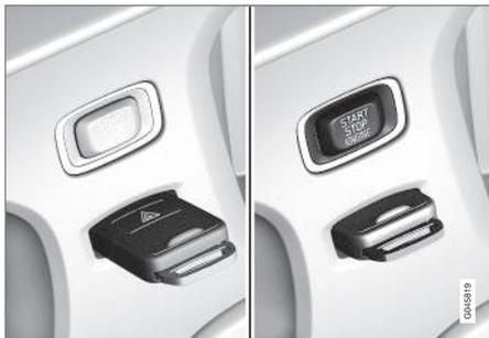
Interruptor de ignição com comando à distância ejectado/inserido.
