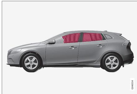
A cortina de colisão IC (Inflatable Curtain) é parte integrante do sistema SIPS (pág. 37). Esta encontra-se montada ao longo de ambos os lados do forro do tecto e ajuda a proteger o condutor e os passageiros nos lugares laterais do automóvel. Perante uma colisão suficientemente forte, os sensores reagem e a cortina de colisão é insuflada.
