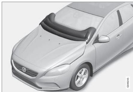
O airbag para os peões (Pedestrian Airbag) encontra-se montado sob o capot, junto ao pára-brisas. Perante algumas colisões frontais com um peão reagem os sensores no pára-choques dianteiro e o airbag é insuflado caso a violência da colisão assim o determine. Os sensores estão activos a uma velocidade entre 20-50 km/h e com uma temperatura exteriores entre -20 e +70 °C.
