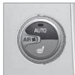
Rode o botão para aumentar ou diminuir a velocidade do ventilador, **AUTO** é desligado. Se for seleccionado **AUTO**, a velocidade do ventilador é regulada automaticamente (pág. 137) - a velocidade anteriormente ajustada é desactivada.
