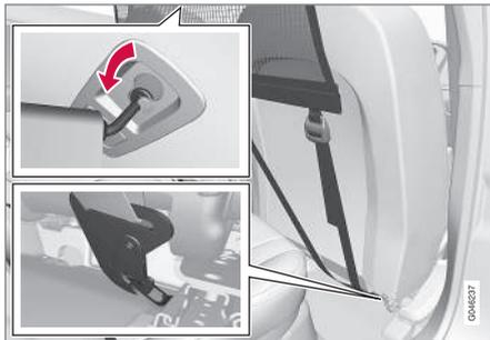
4. Engate a rede de carga nos olhais traseiros dos trilhos de deslizamento dos bancos - facilita se as costas do banco estiverem levantadas e os bancos forem deslocados ligeiramente para a frente.
