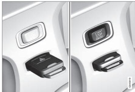
Interruptor de ignição com comando à distância ejetado/inserido e botão **START/STOP ENGINE**.
