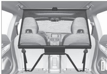
*A rede de carga é montada em quatro pontos de fixação.*
