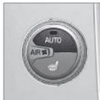
A função auto comanda automaticamente a temperatura (pág. 137), o ar condicionado (pág. 138), a velocidade do ventilador (pág. 136), a recirculação (pág. 139) e a distribuição
