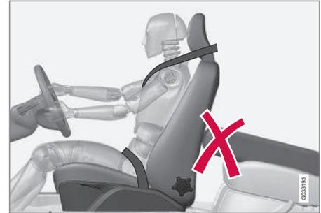
Não coloque qualquer objecto no banco traseiro que possa evitar o funcionamento do sistema WHIPS.
