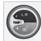
As temperaturas nos lados do condutor e do passageiro podem ser reguladas de modo independente. Pressione no botão **L/R** várias vezes para seleccionar o ajuste para a esquerda,
