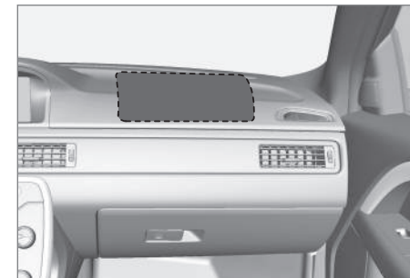
Umístění airbagu předního spolujezdce ve voze s levostranným řízením.
