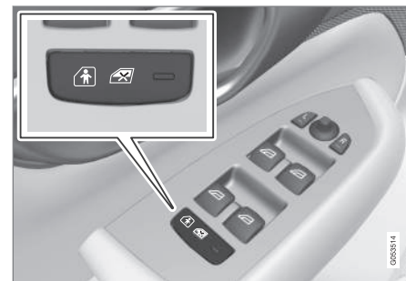
Botão para ativação e desativação elétrica.
