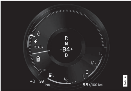
O mostrador do condutor indica carregamento na travagem com o motor eléctrico.
