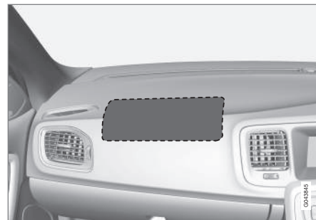
Plassering kollisjonspute på passasjersiden i bil med høyerratt.
