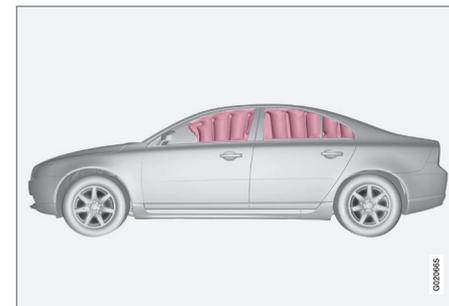
La cortina inflable IC (Inflatable Curtain) forma parte del sistema SIPS (p. 30) y el sistema de airbags (p. 26). El sistema IC está instalado a lo largo de ambos lados del techo interior y protege a las personas que ocupan las plazas laterales del automóvil. En caso de una colisión de suficiente intensidad, los sensores reaccionan y el airbag de techo lateral se infla.
