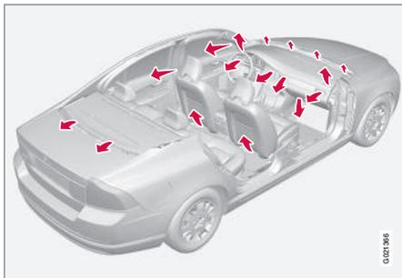
En la posición **AUTO**, la distribución del aire es completamente automática.
