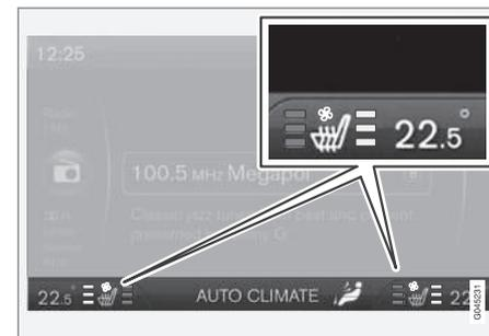
El nivel de confort se indica en la pantalla de la consola central.
