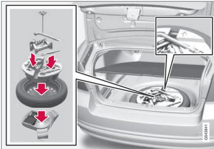
Debajo del piso del compartimento de carga se guardan la anilla de remolque, el gato\* y la llave para los tornillos de rueda\* del automóvil. También hay sitio para la llave de los tornillos de seguridad de la llanta.
