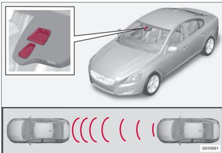
Ventanas del emisor y el receptor del sensor láser<sup>13</sup>.
