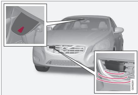
Sensor de cámara y de radar<sup>22</sup>.
