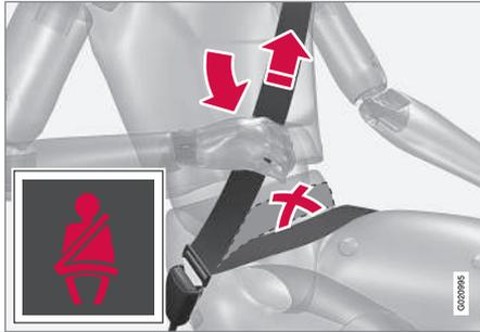
Para que el cinturón de seguridad proporcione la máxima protección es importante que vaya pegado al cuerpo. No incline el respaldo demasiado hacia atrás. El cinturón de seguridad está concebido para proteger en una posición normal de asiento.
