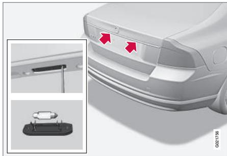
1. Suelte los tornillos con un destornillador.
