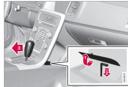
Si el automóvil no está en condiciones para conducirse, por ejemplo, si la batería de arranque está descargada, el selector de marchas debe sacarse de la posición **P**, para poder mover el vehículo.
