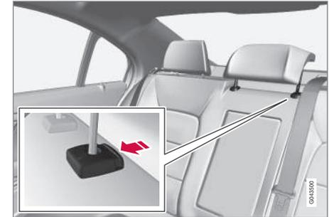
El reposacabezas se regula en altura según la altura del pasajero. El borde superior se adapta a la mitad de la nuca. Suba el reposacabezas según sea necesario.
