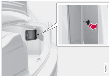
1. Abra o retire la tapa lateral en el maletero (en el mismo lado que la tapa del depósito) y busque un cable de color verde con balanca.
