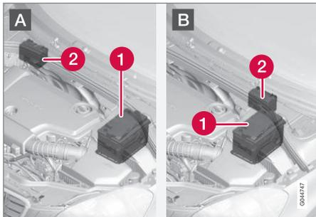
A: Automóvil con volante a la izquierda. B: Automóvil con volante a la derecha. (1). Batería de arranque<sup>12</sup> (2). Batería de apoyo.
