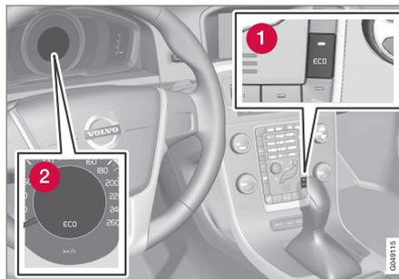
1 Conexión y desconexión de ECO
