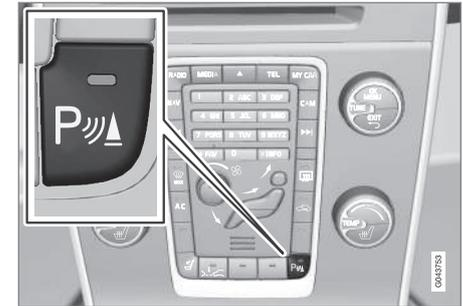
Conexi n y desconexi n del aparcamiento asistido.
