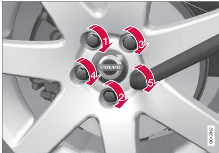
4. Apriete los tornillos de rueda por pares cruzados. Es importante que los tornillos de rueda queden debidamente apretados. Apriete a 140 Nm. Compruebe el apriete con una llave dinamométrica.
