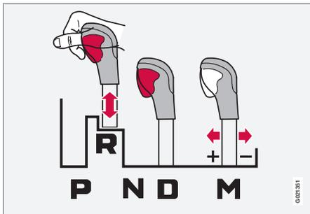
La palanca puede desplazarse libremente hacia adelante o hacia atrás entre **N** y **D**. Las demás posiciones tienen un bloqueo que se controla con el botón de bloqueo del selector de marchas.
