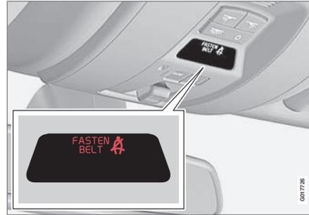
El aviso acústico depende de la velocidad y, en algunos casos, del tiempo. La señal luminosa se puede ver en la consola del techo y en el cuadro de instrumentos (p. 56).
