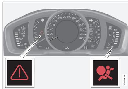
Triángulo de advertencia y símbolo de advertencia del sistema de airbags (p. 26) en el cuadro de instrumentos analógico.
