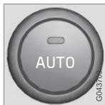
Al seleccionar una o varias funciones manuales, las demás funciones siguen regulándose automáticamente. Cuando se pulsa el botón **AUTO**, se desconectan todos los ajustes manuales. La pantalla muestra **CLIMA AUTO**.
