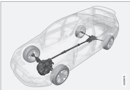
Con la tracción integral (All Wheel Drive), el vehículo avanza impulsado por las cuatro ruedas.
