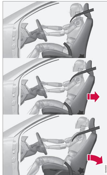
El sistema WHIPS se activa durante una colisión por alcance en función del ángulo de incidencia, la velocidad y las características del vehículo con el que se choca.
