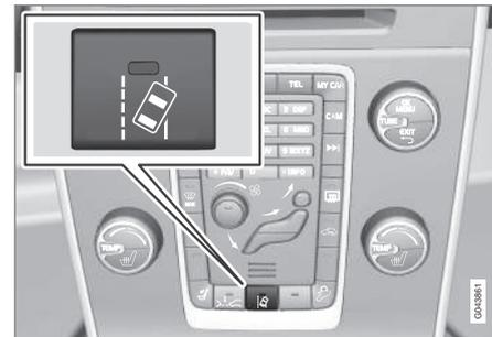
La función LDW se conecta y desconecta con un botón situado en la consola central. La luz del botón se enciende cuando la función está conectada.
