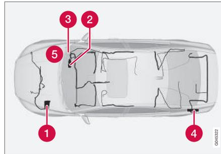
Ubicación de las cajas de fusibles y relés en automóviles con volante a la izquierda. Si el automóvil lleva el volante a la derecha, cambia de lado la caja de fusibles y relés situada debajo de la guantera.
