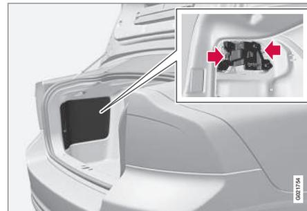
Las bombillas de las luces traseras se cambian desde el interior del maletero (excepto las bombillas LED).
