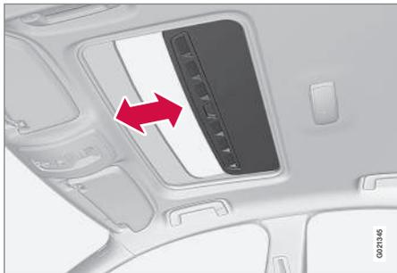
Si se mantiene pulsado el botón de cierre, se cierra el techo solar y todas las ventanillas, véase Mando a distancia - funciones (p. 158) y Cierre y apertura - en el interior (p. 171). Las puertas y el maletero se cierran. Si es necesario interrumpir el movimiento de cierre, pulse de nuevo el botón de cierre.
