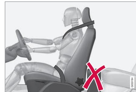
*No coloque en el piso detrás del asiento del conductor o del acompañante objetos que puedan impedir el debido funcionamiento del sistema WHIPS.*
