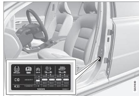
La placa de presión de neumáticos situada en el montante de la puerta del lado del conductor (entre la puerta delantera y la trasera) especifica la presión que deben tener los neumáticos en diferentes condiciones de carga y velocidad. Estos datos se indican también en la tabla de presiones de neumáticos, véase Neumáticos - presiones de inflado aprobadas (p. 404).
