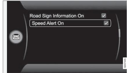
El conductor puede optar por recibir una advertencia en caso de rebasar el límite de velocidad vigente en 5 km/h o más. La advertencia se presenta a través del parpadeo temporal del símbolo con el límite de velocidad aplicable al superarse ésta. El sistema puede conectarse y desconectarse en el sistema de menús **MY CAR**. Para una descripción del sistema de menús, véase MY CAR (p. 108).
