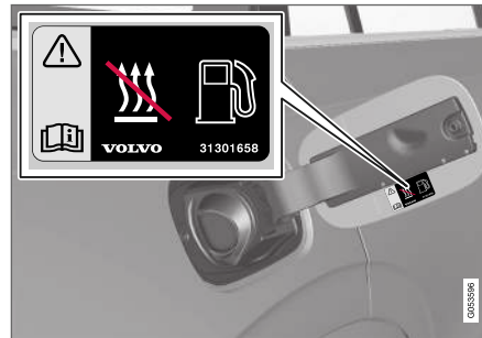
Πινακίδα στο εσωτερικό της θυρίδας ρεζερβουάρ καυσίμων.
