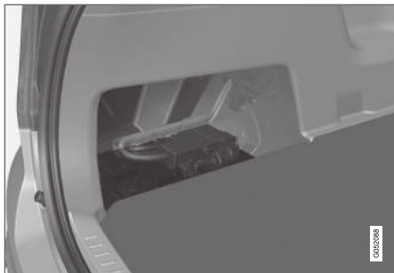
Η μπαταρία εκκίνησης βρίσκεται στον χώρο αποσκευών.
