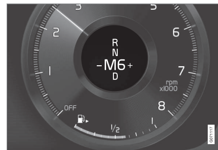
Přehled - schéma řazení na displeji řidiče u malé řadicí páky.
