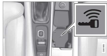
Umístění záložní čtečky v tunelové konzole.
