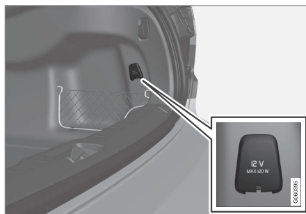
Prise 12 V dans le coffre/compartiment de chargement*.
