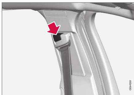
Hoogte-instelling van de veiligheidsgordel. Druk de knop in en zet de gordel hoger of lager. Zet de gordel zo hoog mogelijk zonder dat de gordel daarbij langs de nek schuurt.
