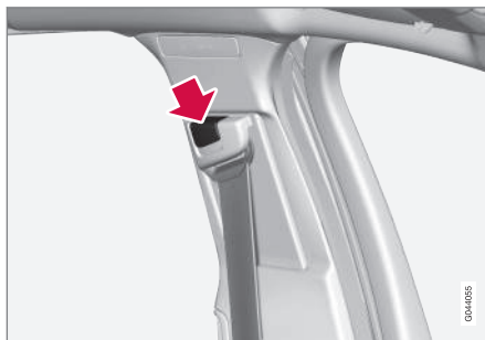
Turvavyön korkeussäätö. Painakaa painiketta ja siirtäkää vyötä korkeussuunnassa. Asettakaa vyö mahdollisimman korkealle ilman, että se hankaa kaulaa.
