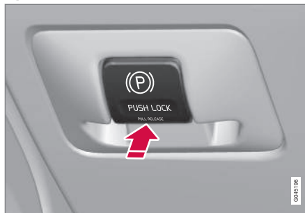
Comando do travão de estacionamento - aplicado.
