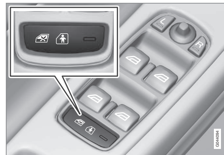
Painel de comando da porta do condutor.
