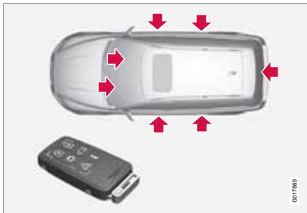
Låspunkter för fjärrnyckel med nyckelblad.
