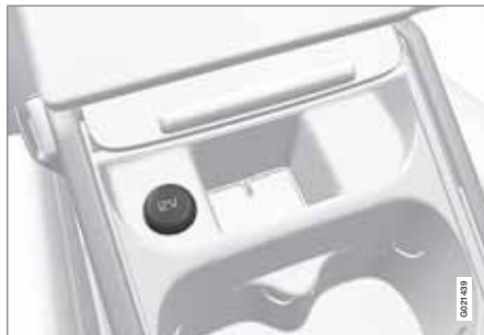
12 V-uttag i tunnelkonsol, framsäte.
