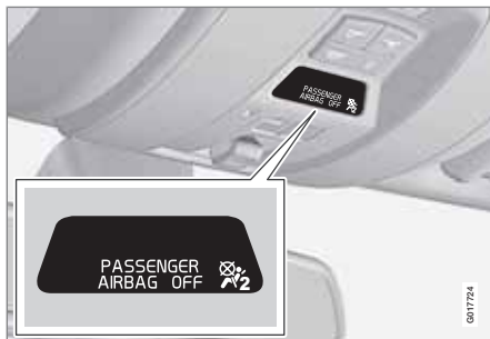
Indikering som visar att passagerarplatsens krockkudde är avaktiverad.
