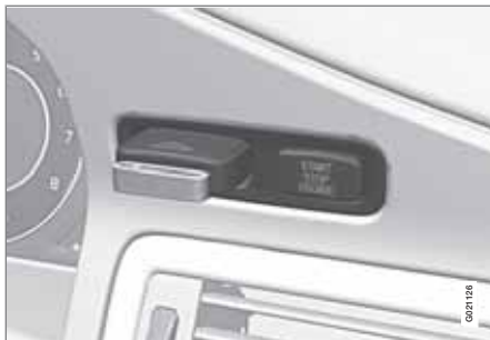
Startlås med indragen fjärrnyckel.
