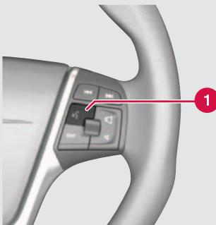
La funzione di comando vocale (disponibile solo sulle auto dotate di sistema di navigazione opzionale) può essere utilizzata per attivare determinate funzioni su un telefono cellulare abilitato Bluetooth® e sul sistema di navigazione.
