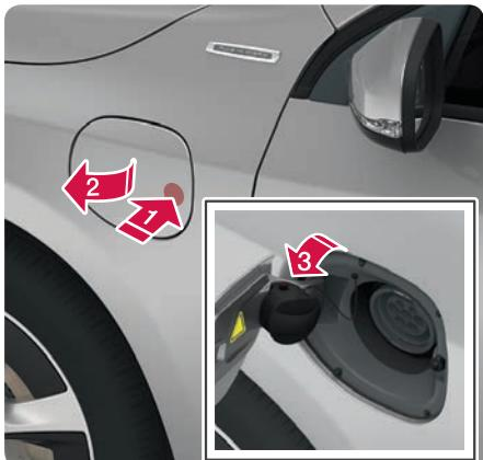
Das Schließen des Deckels für den Ladeanschluss erfolgt in umgekehrter Reihenfolge.
