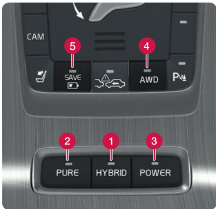
Das Fahrzeug wird von zwei Motoren angetrieben – einem Elektro- und einem Dieselmotor. Es können verschiedene Fahrmodi gewählt werden. Sie können keinen „falschen“ Fahrmodus wählen – wenn bestimmte Bedingungen nicht erfüllt sind, wechselt das Fahrzeug wieder in den HYBRID-Modus. In diesem Fall leuchtet die Lampe in der Hybrid-Taste auf.
