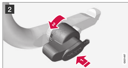
2 Den Verriegelungsknopf 1 eindrücken und gegen den Uhrzeigersinn drehen 2 , bis ein Klicken zu hören ist.
