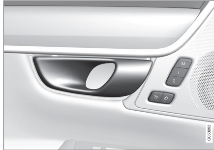
Öppningshandtag för alternativ upplåsning i sidodörr 11 .
