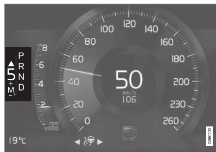
Växlingsindikator i 8-tums förardisplay för stor växelspak.
