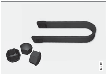
เครื่องมือสำหรับการถอดจุกปิดพลาสติกบนน็อตล้อ
