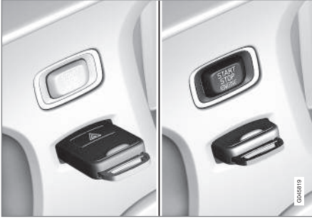
Uzaktan kumanda anahtarlı kontak anahtarı çıkartıldı/takıldı.
