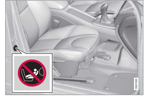
Yolcu tarafı kapı direğindeki etiket. Etiket yolcu kapısı açıldığında görünür.
