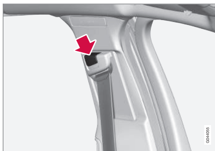
Højdejustering af sikkerhedssele. Tryk på knappen og bevæg selen i højden. Anbring selen så højt som muligt, uden at den gnider mod halsen.
