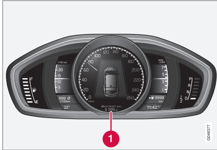
Triptællere, digitalt instrument.
