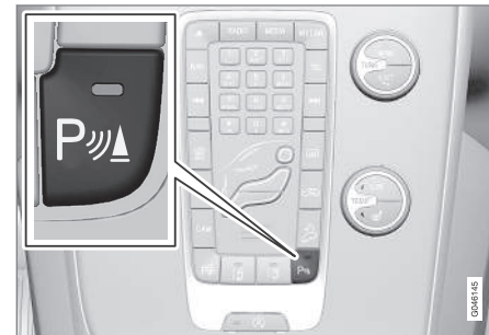
Til-/fra for sensorerne til Parkeringshjælp og CTA 37 .
