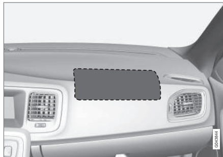
Θέση του αερόσακου συνοδηγού σε αριστερότιμο αυτοκίνητο.
