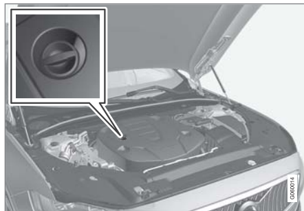
ท่อเติมน้ำมัน 13
