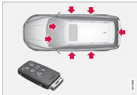
附帶鑰匙片的遙控器有效鎖定位點。
