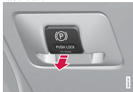
駐車煞車控制 - 釋放。
