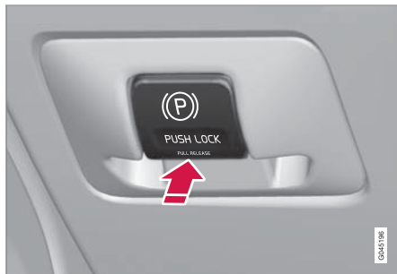
駐車煞車控制 - 使用。
