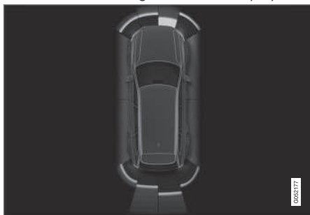
Bildskärmsvy med hinderzoner och sensorsektorer.
