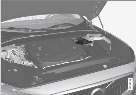
12 V stödbatteriet är placerat i en box bredvid fjäderbenstornet.
