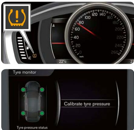
更換輪胎或改變胎壓後, 務必進行校正。燈光照明時, (⚠) 系統需要校正。依據下列步驟進行:
