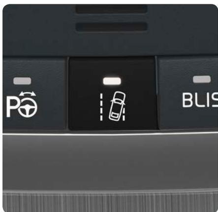
當汽車將要跨越邊線時，LKA 會在方向盤上施加輕微的轉向扭力，主動將汽車轉回車道內。若汽車跨越了邊線，LKA 會透過方向盤的震動向您提出警告。
