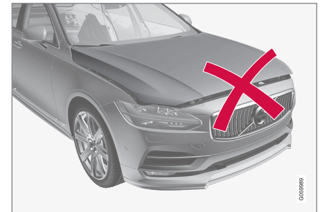
Cofano non completamente chiuso.
