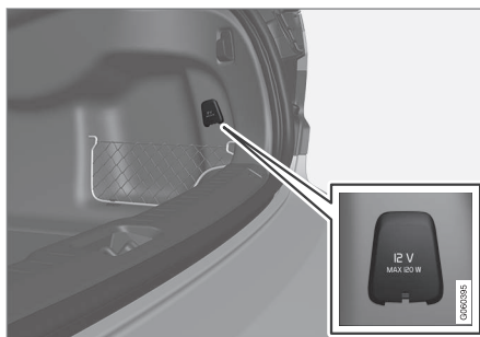
Presa elettrica da 12 V nel bagagliaio*.
