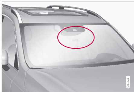
Posizione del gruppo radar.
