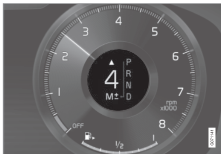
Indicatore cambio di marcia sul display del conducente da 12" per la leva selettore grande*.
