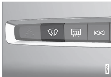
Pulsante fisico nel quadro centrale.
