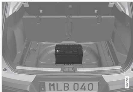
Startbatteriet är placerat i lastutrymmet.
