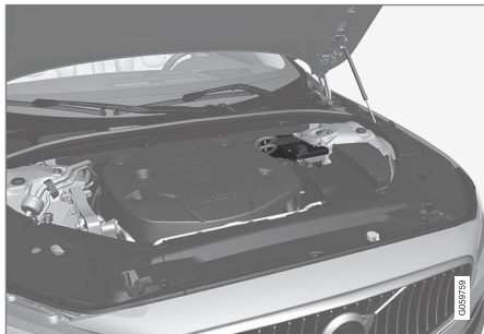
Допоміжний акумулятор 12 В розташований у відсіку поряд із чашкою стійки амортизатора.
