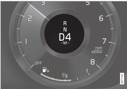
Дисплей водія під час зміни передач підкресловими пелюстками, маленький важіль КПП.
