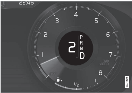
Дисплей водія під час зміни передач підкресловими пелюстками, великий важіль КПП.
