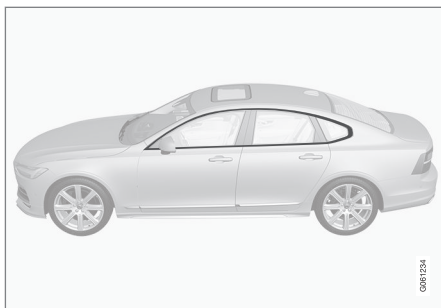
Деталі, які слід мити м'яким засобом із значенням рН від 3,5 до 11,5.
