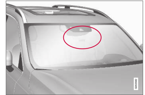
Ubicación de la unidad de radar.
