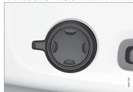
多功能控制器，位於座椅的座部側面。
