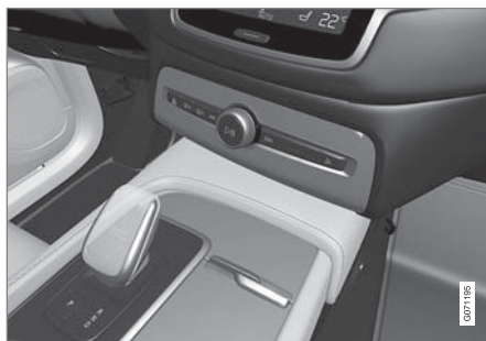
無法停用排檔桿抑制器的小型排檔桿概覽。
