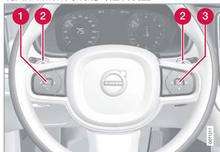
方向盤上的鍵盤與撥片*。
