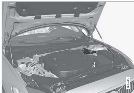
12 V 支援電瓶位於引擎室。
