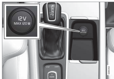
前座中央扶手上的 12 V 電源插座。
