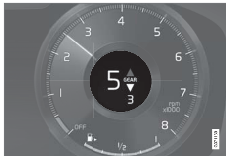
12 吋駕駛人顯示器*中的換檔指示器。
