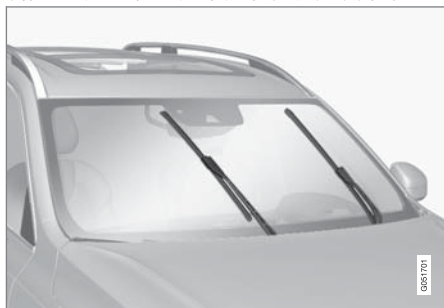
位於維修位置的雨刷片。
