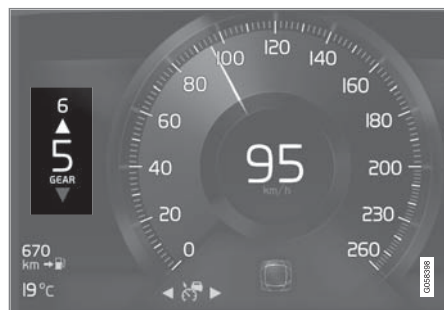
8 吋駕駛人顯示器中的換檔指示器。
