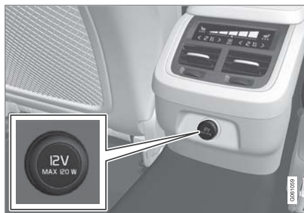
後座中央扶手上的 12 V 電源插座。
