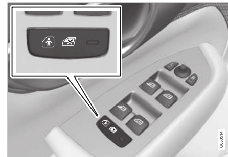
Pulsante di attivazione e disattivazione elettrica.
