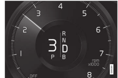
Display del conducente in caso di cambio marcia con le leve al volante.
