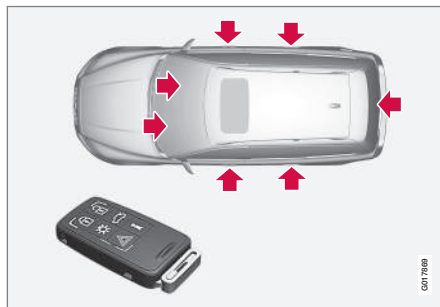
Ενεργές κλειδαριές για το τηλεχειριστήριο-κλειδί με αποσπώμενο κλειδί.
