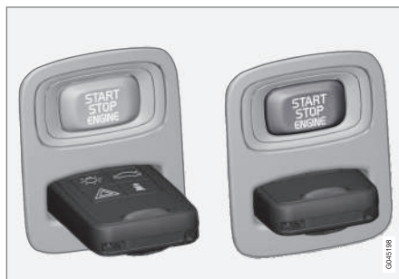
Διακόπτης ανάφλεξης με βγαλμένο/τοποθετημένο το τηλεχειριστήριο-κλειδί.
