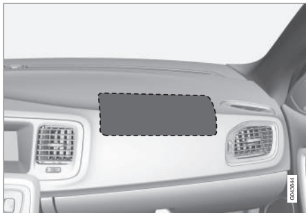
Θέση του αερόσακου συνοδηγού σε αριστεροτίμονο αυτοκίνητο.
