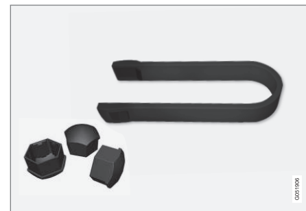
Værktøj til at fjerne hjulboltens plastkapsler.
