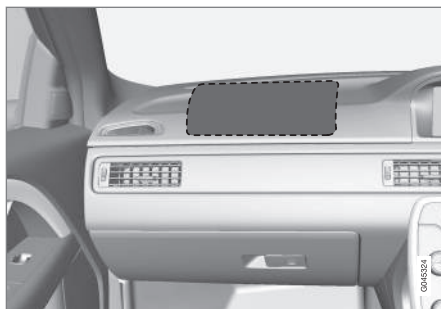
Placering af airbag i passagersiden i højrestyret bil.
