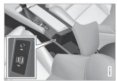
中央扶手控制台中的 USB 插槽。
