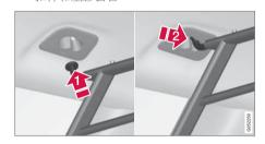
2. 將防護格柵的一個掛鉤拉到車頂固定件 (1)的較大開口。
