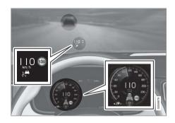
上圖 <sup>11</sup> 顯示 Pilot Assist 設定為保持 110 km/h,同時跟隨保持相同速度的前車。
