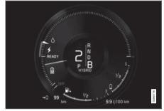
駕駛人顯示器顯示電動馬達煞車時的充電狀態。
