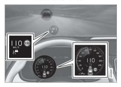
上圖 <sup>8</sup> 顯示主動式定速巡航控制設定為保持 110 km/h,同時跟隨保持相同速度的前車。
