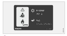
②使用 R1234yf 冷媒車輛的空調系統資訊。
