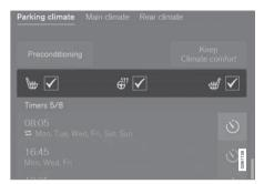
恆溫控制畫面駐車溫度控制頁籤中的座椅加熱及方向 盤加熱框格。
