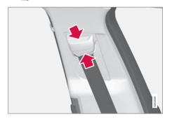
同時按下座椅固定點並上下移動安全帶。 請在不摩擦到喉嚨的前提下,盡可能將安 全帶向上移。
