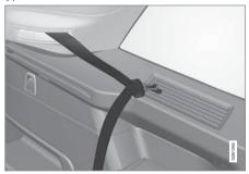
將第三排座椅的安全帶鎖片掛在側板上的 指定掛幻處。
