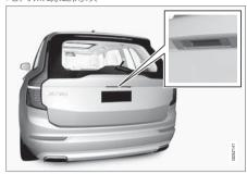
具有壓力感應表面的橡膠壓板。
