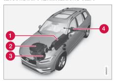
1 混合動力電池 - 混合動力電池的功能是 儲存電力。其接收電力的方式是從電源電 路充電、於再生煞車期間充電,或是藉由 高壓發電機充電。其是為電動行駛以及乘 客室預先調節期間的電動空調功能暫時運 作進行供電。
