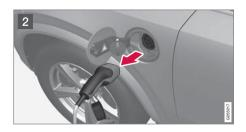
2 請將電線從汽車的充電輸入插座拔下,裝 回充電輸入插座的蓋子並關閉艙蓋。
