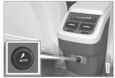
中央扶手控制台中的點菸器,第二排座椅。
