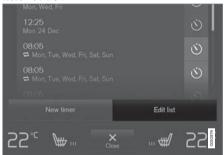
在恆溫控制畫面駐車溫度控制頁籤中編輯清單/刪除時間設定的按鈕。
