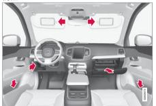
車門板、方向盤處、手套箱及遮陽板的儲存格。
