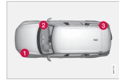
左駕車型內中央電氣元件的位置。在右駕車型 內,手套箱下方中央電氣元件的位置會換到另 一側。
