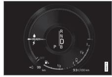
混合動力量表會以不同方式顯示從電動馬達取出的動力量與可用動力量之間的關係。
