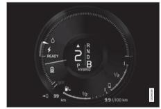
例如當您輕踩煞車踏板或下坡路段使用引擎煞車時,車輛會產生電流為電瓶充電。
