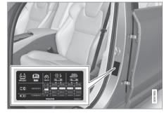
駕駛側車門柱(前後車門之間)內側的輪胎壓力標籤顯示在不同負荷和車速下的輪胎壓力。
