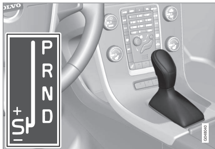
D - Automata fokozathelyzetek. +/- - Manuális fokozathelyzetek. S - sport üzemmód*.
