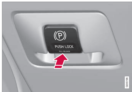
A rögzítőfék kezelőszerve - behúzás.
