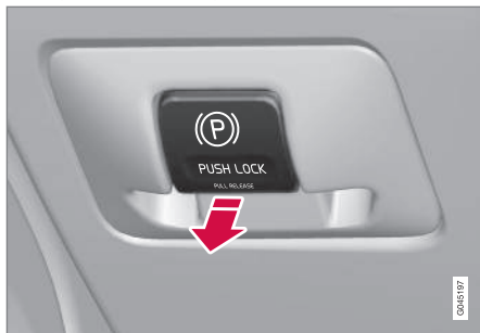
A rögzítőfék kezelőszerve - kiengedés.
